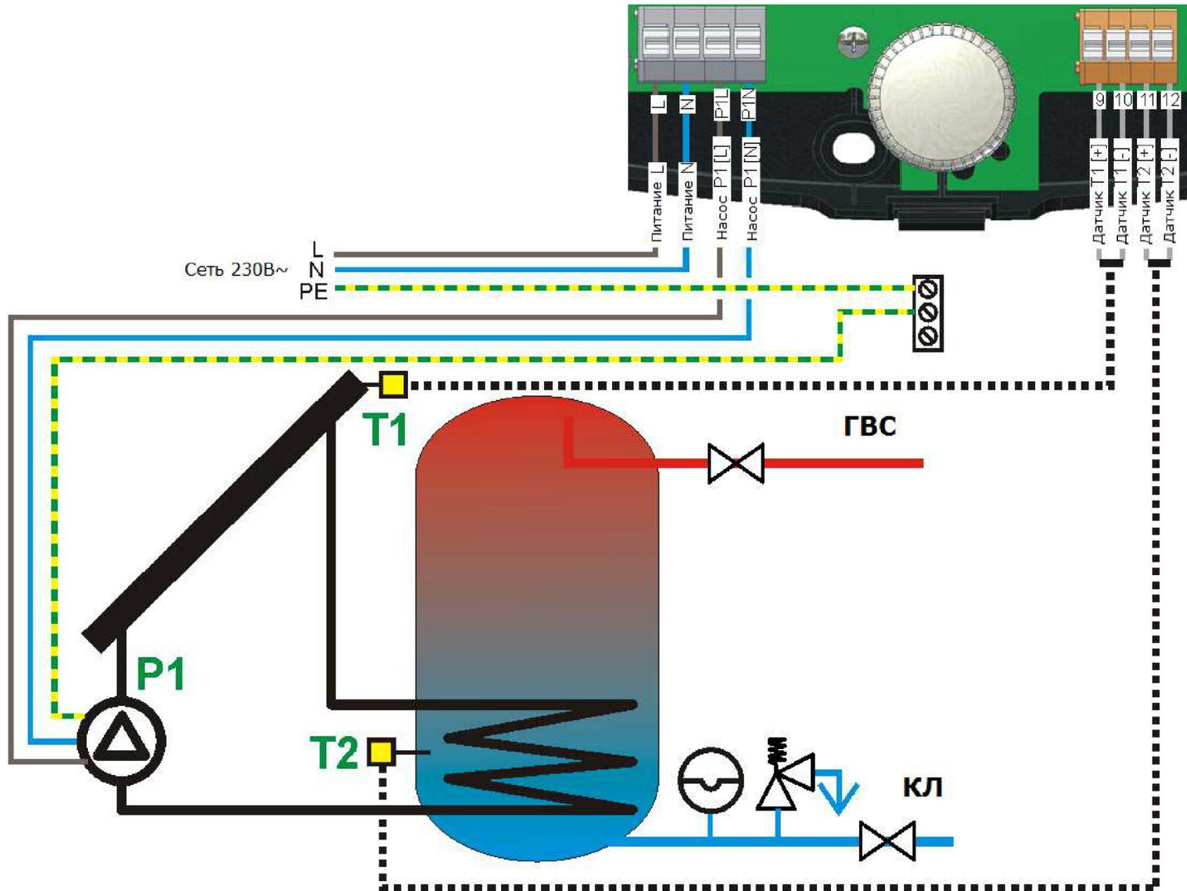
Рис. 12.1 Базовая гидравлическая схема
