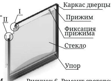
Рисунок 6. Ремонт светорозрачного экрана дверцы модификации «Люмина»
