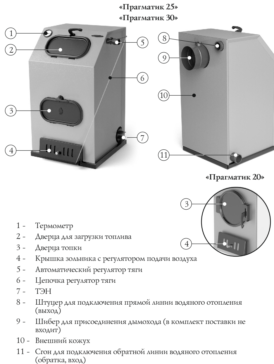
Рисунок 7. Внешний вид водогрейного котла «Прагматик Электро».
