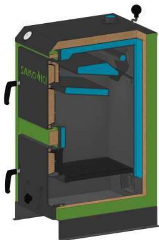
Рис. 1 Разрез котла SAKOVICH STANDART
