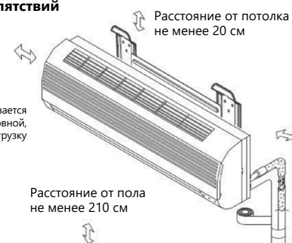
Поверхность стены, на которой устанавливается внутренний блок, должна быть гладкой и ровной, конструкция стены должна выдерживать нагрузку не менее 60 кг.
