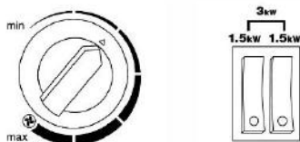
3-сурет. BRICK 3 моделіне арналған басқару панелі: термостатты реттеу тұтқасы (оң жақта ). Режимдерді ауыстырып- қосқыштар ( сол жақта)
