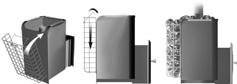
Рисунок -8. Установка сетки-каменки на печь.
