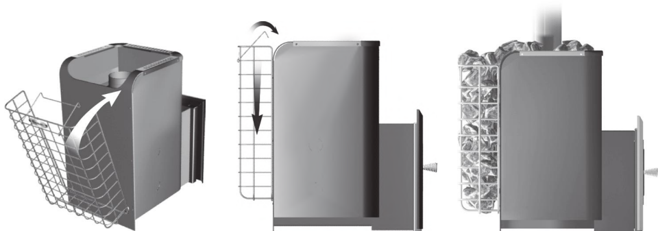
Рисунок -8. Установка сетки-каменки на печь.
