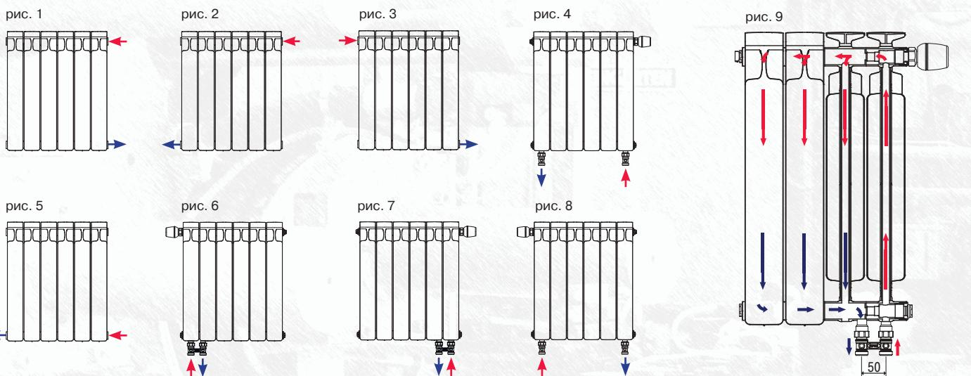
Принципиальная схема движения теплоносителя при нижнем подключении рис. 9.
