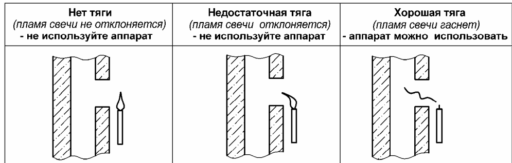
Рисунок 4. Способ проверки тяги в дымоходе
