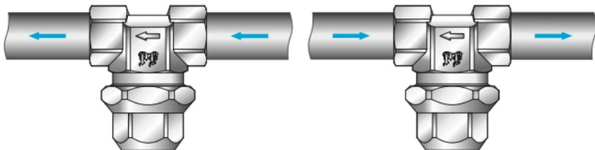
Фильтр не должен испытывать нагрузок от трубопровода (изгиб, сжатие, растяжение, кручение, перекосы, вибрация, несоосность патрубков, неравномерность затяжки крепежа).
