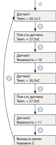
Просмотр показаний датчиков (Система для крыши)
