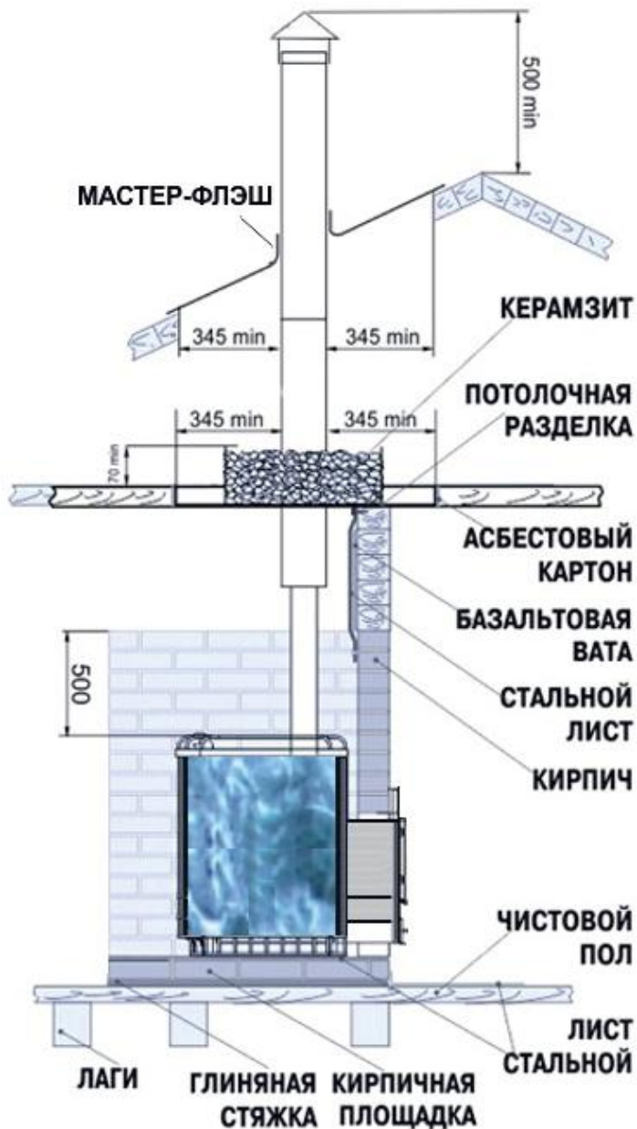
Рис. 3 Схема установки печи, вид сбоку
