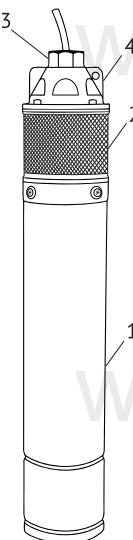
Насос состоит из электродвигателя и гидравлической части, которые расположены в кожухе из нержавеющей стали (1). Гидравлическая часть вихревого типа, рабочие колеса выполнены из латуни.
