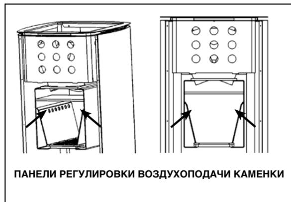
ПАНЕЛИ РЕГУЛИРОВКИ ВОЗДУХОПОДАЧИ КАМЕНКИ
