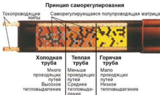
Рис.4. Принцип работы саморегулирующейся тепловыделяющей матрицы.
